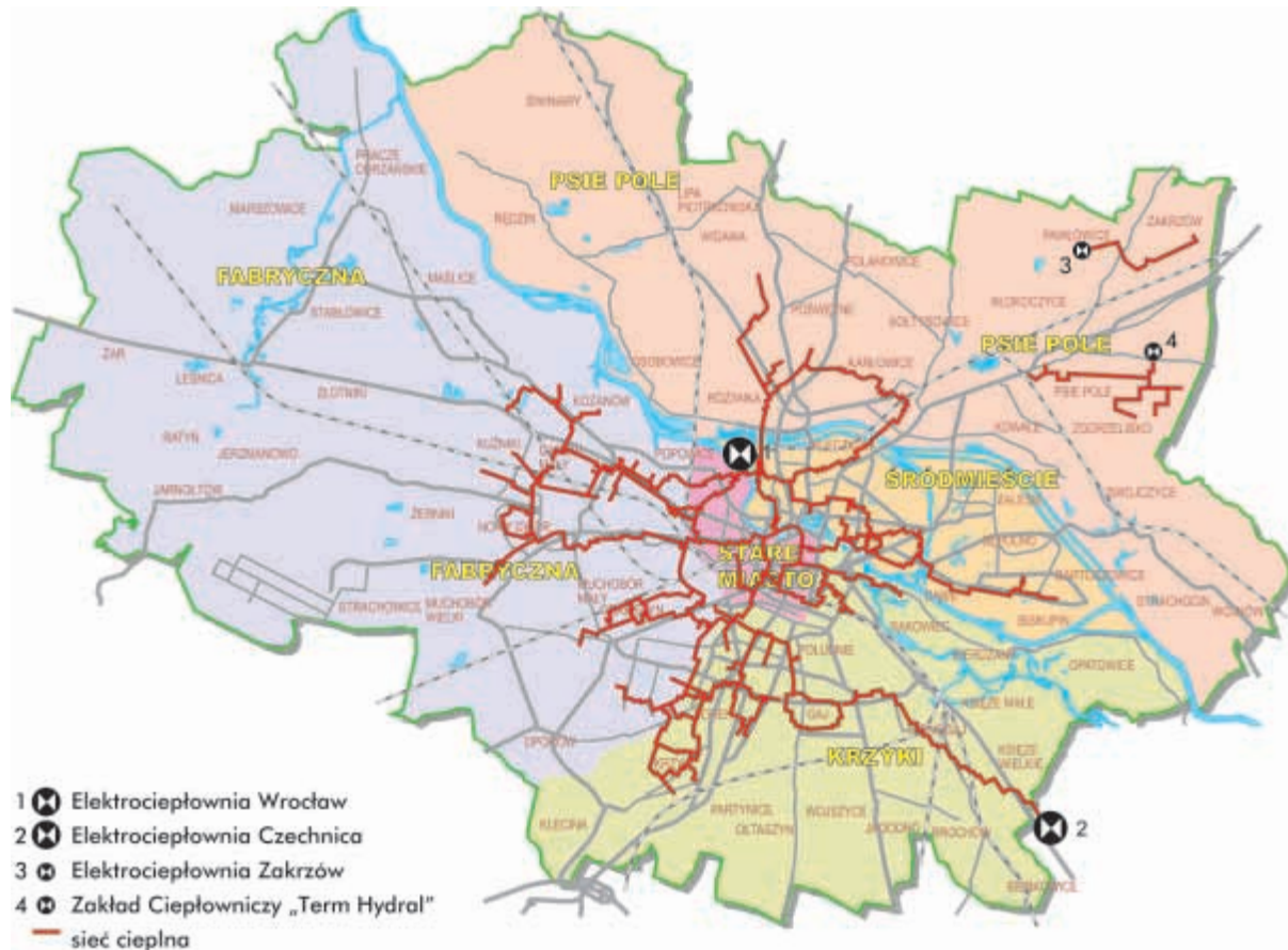
Rysunek 7. Schemat sieci ciepłych Wrocławia
