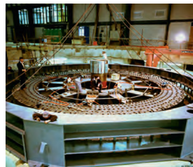
Fot. 26.15. Jedno z dwóch kół zamachowych w zakładzie badań nad syntezą jądrową w Culham (w budowie).
